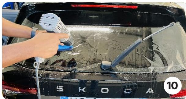
Votre H doit commencer du milieu, de droite à gauche, puis du milieu vers le haut, puis vers le bas pour les côtés. Chauffez DOUCEMENT les tunnels, puis raclez l'air vers l'extérieur. Répétez l'opération jusqu'au lissage COMPLET du film.
