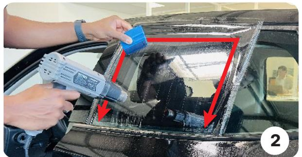
Chauffez DOUCEMENT les tunnels, puis raclez l'air vers le bas. Répétez l'opération jusqu'au lissage COMPLET du film
